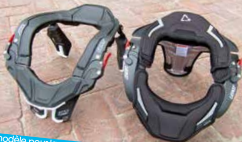
Le modèle pour la route (STX, à gauche) propose des branches arrière qui s'appliquent sur les omoplates, de chaque côté de la traditionnelle bosse des combinaisons de piste. Mais les crossmen ayant besoin de plus de mobilité, le modèle tout-terrain a une languette centrale qui prend appui sur la colonne, ce qui est source de polémique.
